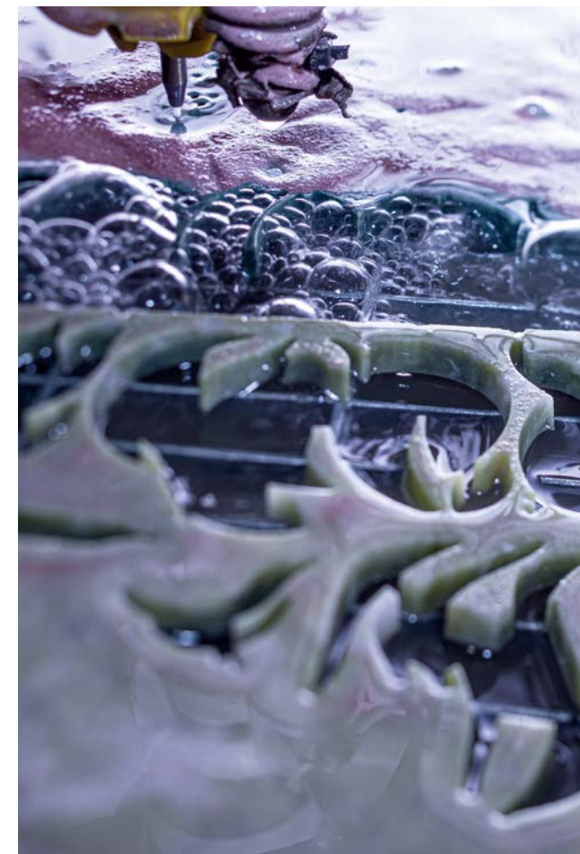
Dettaglio del taglio waterjet in un decoro intarsiato. Detail of the waterjet cut in an inlay decoration.
