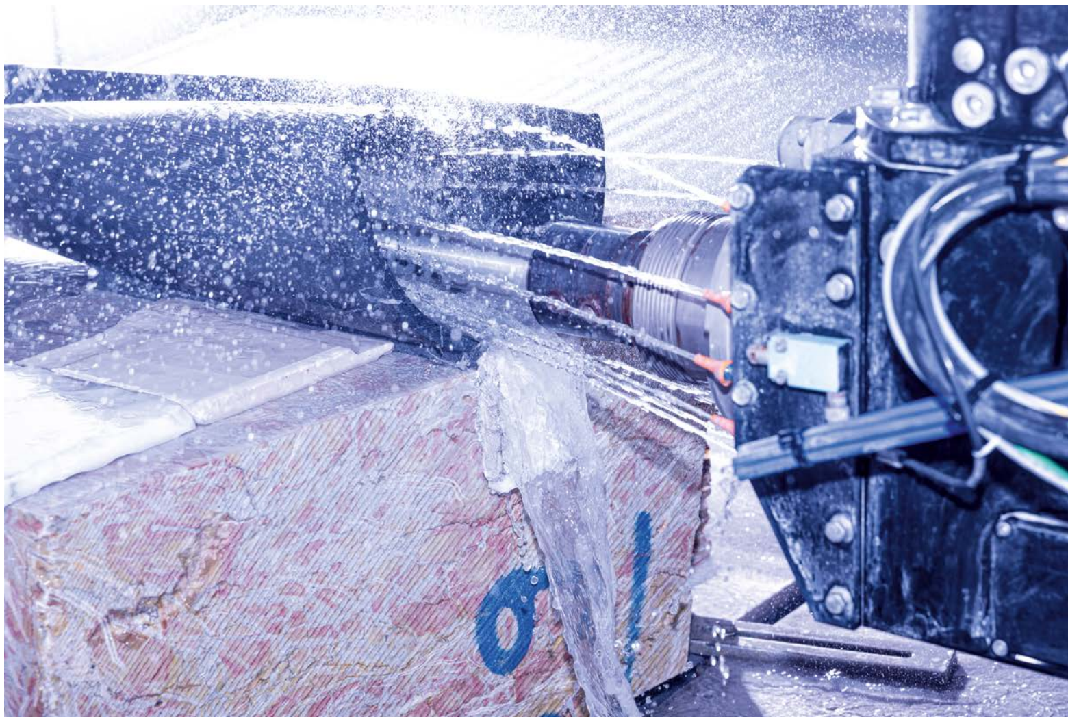
Particolare del taglio del marmo con un getto d'acqua ad altissima pressione. Detail of the marble cutting with a very high-pressure water jet.
