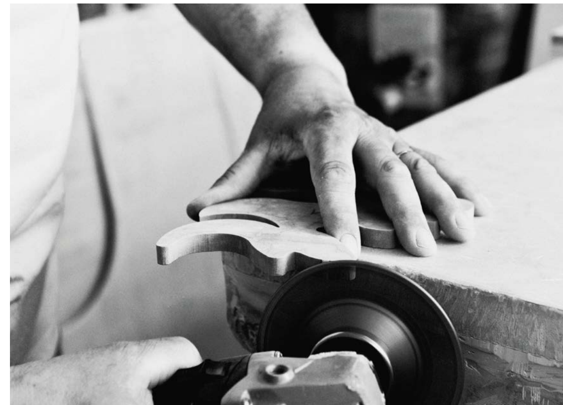
Finitura manuale di bordi, bassorilievi e intarsi. Manual finishing of edges, bas-reliefs and inlays.
