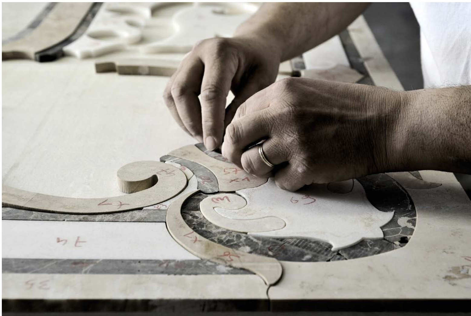
Assemblaggio degli elementi di un intarsio, realizzati con marmi di diverse tipologie e colori. Assembly of the elements of an inlay, made with marbles of different types and colors.
